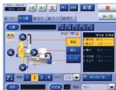
ティーチングと同じ要領でロボットのプログラム変更ができます。ポイントやタイマの追加、動作ごとの速度設定ができます。
